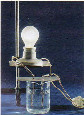
**25.4** Parte del circuito eléctrico que incluye este foco pasa por un vaso con una solución de cloruro de sodio. En la solución, la corriente es transportada tanto por cargas positivas (iones  $Na^+$ ) como por cargas negativas (iones  $Cl^-$ ).
